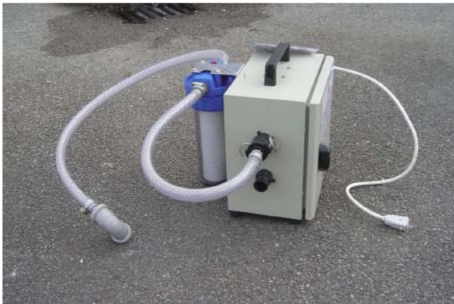
Figura 8.1 Filtrarea apei pentru evacuarea sa din unitatea de decontaminare. Fotografie furnizată de organismul britanic HSE.
