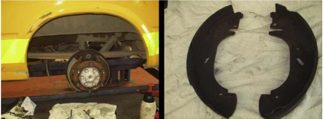
Figura 18.1. Azbest în saboții de frână ai unui camion.
