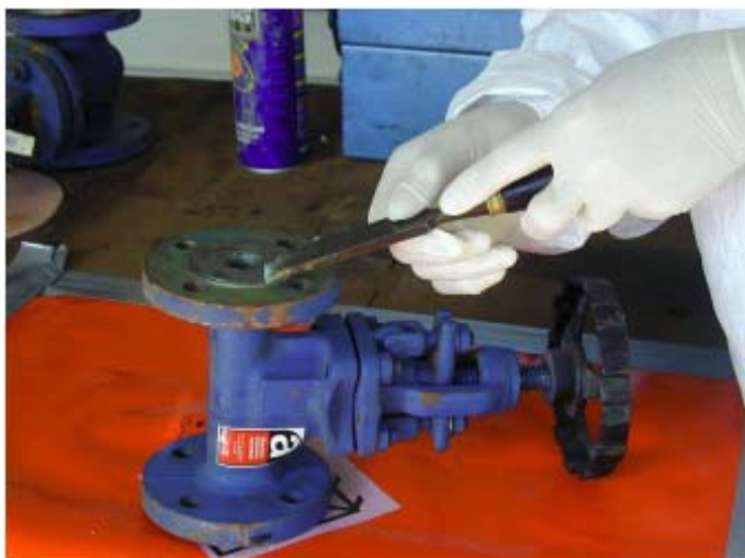
Figura 11.5. Utilizarea numai a uneltelor manuale pentru curățarea garniturilor și joantelor din azbest și a reziduurilor unei vane.
