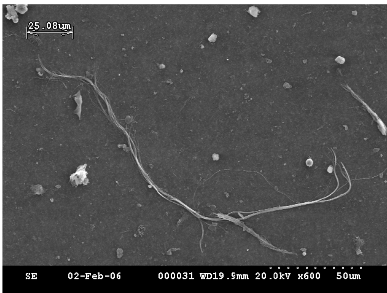
Figura 2.2 Fotografie făcută la microscop electronic cu baleiaj care arată fibre de azbest crisotil
